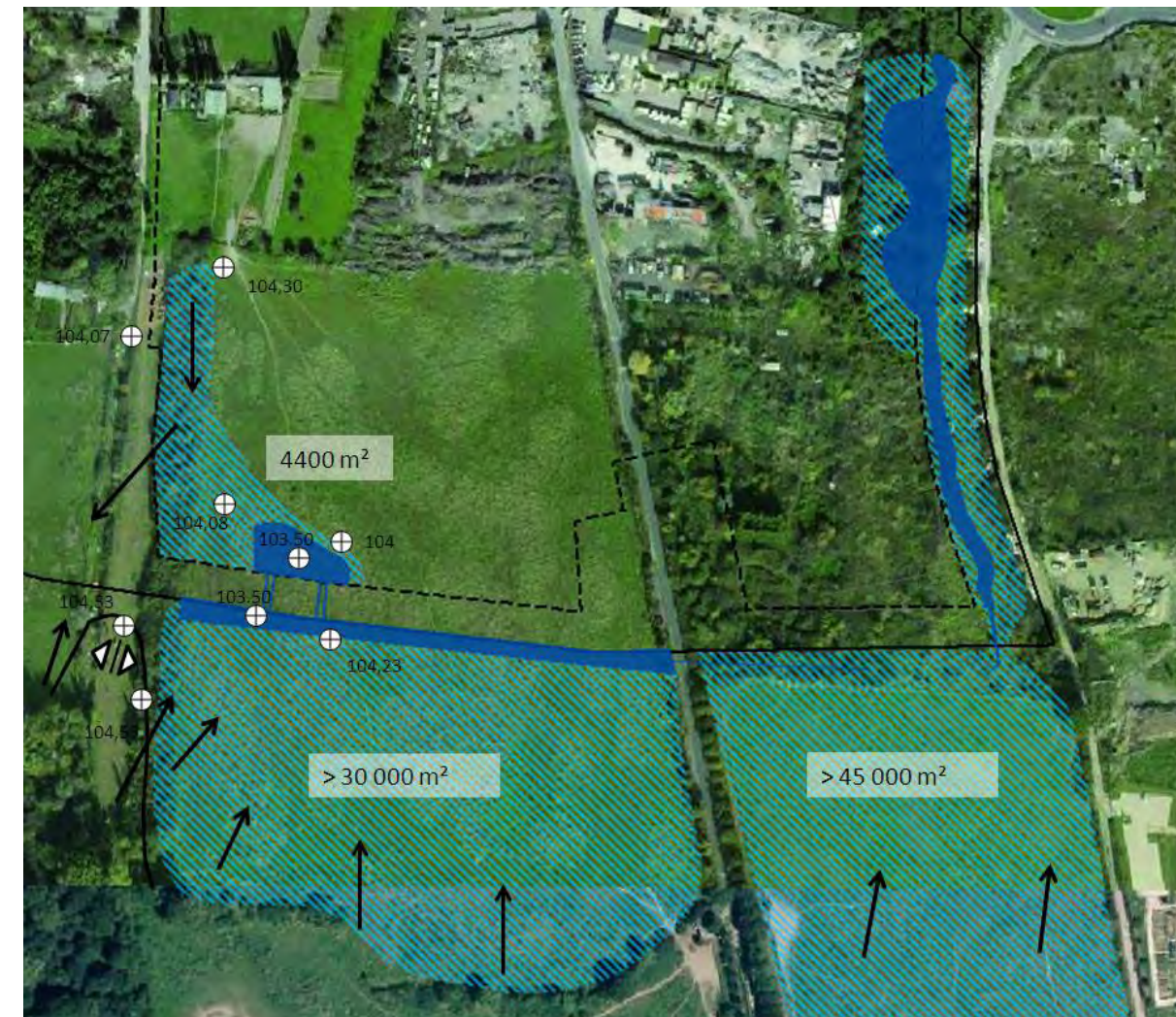
Localisation des impluviums d'alimentation des zones humides
